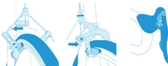
Большинство тормозов, сжимающих обод колеса, имеют специальный разъем, позволяющий развести тормозные колодки в стороны для снятия и постановки колеса. Когда разъем разомкнут, тормоза не могут функционировать. Попросите продавца показать вам, как функционирует разъем тормозных механизмов на вашем велосипеде, перед выездом всегда проверяйте работоспособность обоих тормозов.
